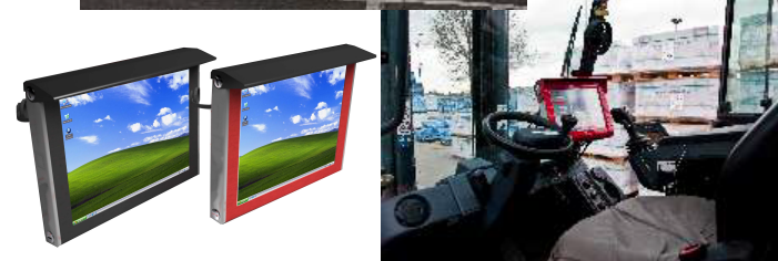
Gabelstapler Ankopplung an SAP über WLAN Access
